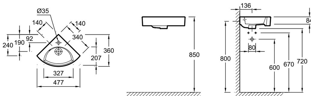
Спецификация продукта : Угловой раковина 34 см. EGP112. Коллекция : ODEON RIVE GAUCHE. РАЗМЕРЫ (СМ) : 34 x 34 см. ВЕС : 7.2 кг. МАТЕРИАЛ : Огнеупорная керамика. ТИП УСТАНОВКИ : Подвесные или могут быть установлены вместе с мебелью. ОТВЕРСТИЯ ДЛЯ СВЕРЛЕНИЯ : 1 отверстие. УСТАНОВКА : Угловая. ОТВЕРСТИЕ ПЕРЕЛИВА : Есть. КОЛИЧЕСТВО РАКОВИН В СТОЛЕШНИЦЕ : 1 раковина. РЕКОМЕНДОВАННЫЙ СМЕСИТЕЛЬ : Odéon Rive Gauche. ДОПОЛНИТЕЛЬНАЯ ИНФОРМАЦИЯ : Смеситель не входит в комплект.
